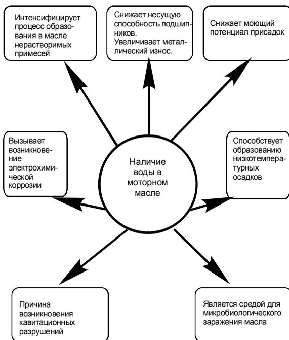
Рис. 1. Влияние обводнения масла на изменение его моторных свойств
