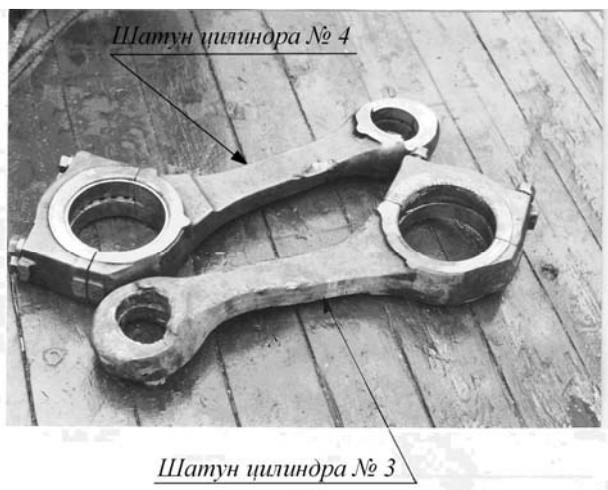
Рис. 3. Фрагмент деформированных шатунов
